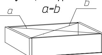
Начните сборку каркаса. Проверьте перпендикулярность и параллельность щитов и зафиксируйте с помощью задней стенки из ДВП, как указано на рисунке, не нарушая диагонали. Помните, что от этого зависит правильность работы выдвижных ящиков и створок.
