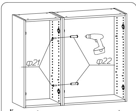
Каждое изделие скрепить между собой стяжкой межсекционной, досверлив отверстия Ø6мм в стенках вертикальных.
